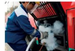
Remplissage d'un véhicule GNL
