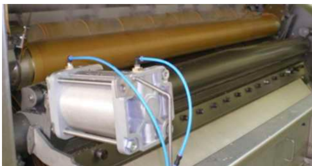
Figure 2 : exemple de sécheur cylindre (Fabricant Andritz Gouda)
