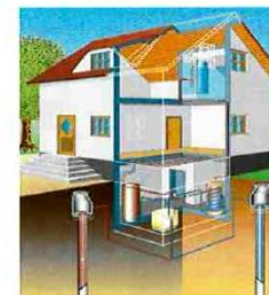
Doublet de forage d'eau
