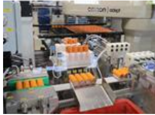
Assemblage des cellules en modules batterie en interne à VI Fauquemont
