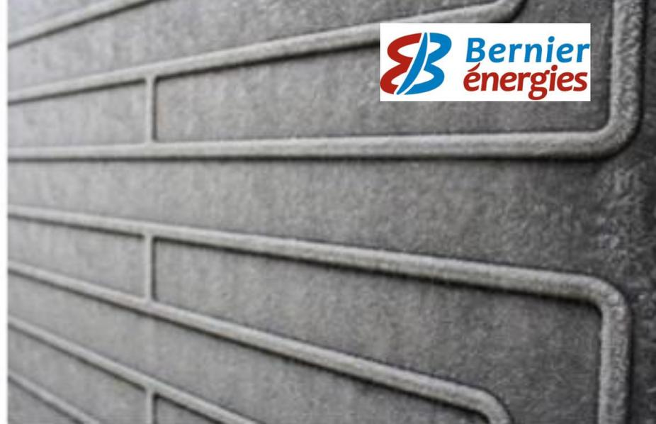
Récupération de chaleur par convection naturelle de l'air et par condensation ou givrage de la vapeur d'eau contenue dans l'air. Dégivrage 100% naturel par l'air ou par le rayonnement solaire.
