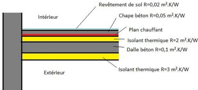
**Calcul de  $R_i$  résistance thermique de la paroi extérieure entre le plan chauffant et l'intérieur :**
