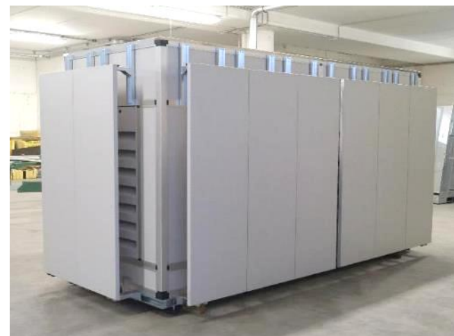
Plaques déflectrices supplémentaires pour augmenter l'atténuation du son côté aspiration
