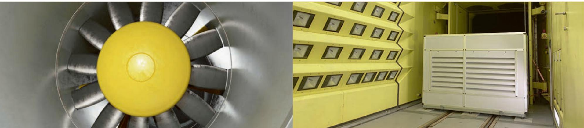
Statik-Test im Windkanal bei 120 km/h
