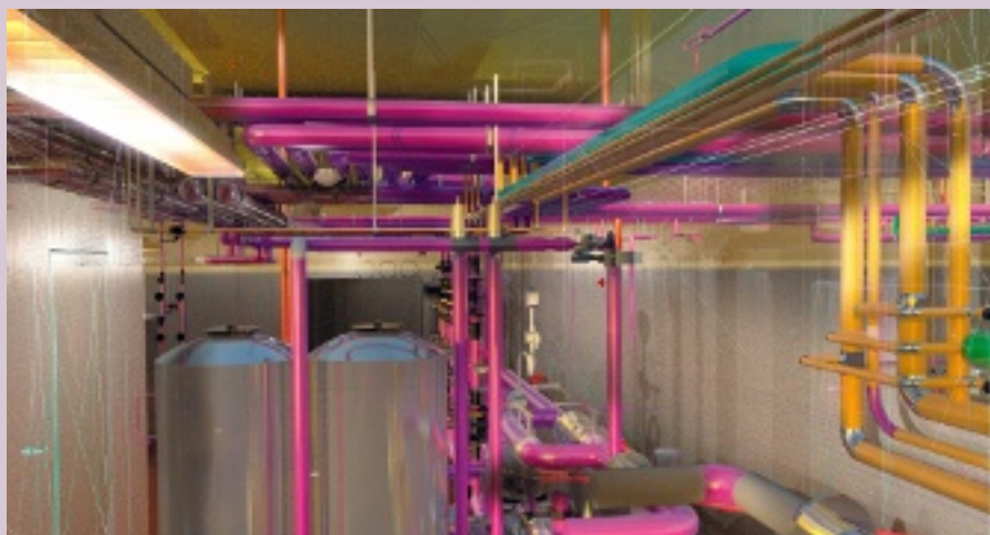
Réseau hydraulique intégré à la maquette numérique avec MagiCad.
